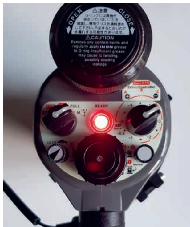
A gauche : mode manuel sélectionné. A droite : puissance définie. Elle pourra être adaptée par la suite.
